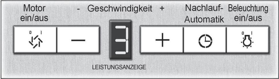
Abb. 2: Bedienfeld elektronische Steuerung
